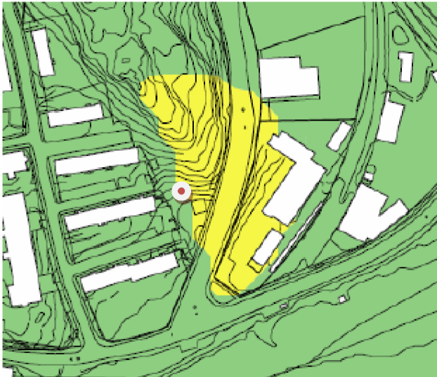
Figur 18. Effekten av nyttjande av mobil skärm vid borrning i position 1. Beräkningspositionen framgår av figuren. (WSP, 2009-03-19)
