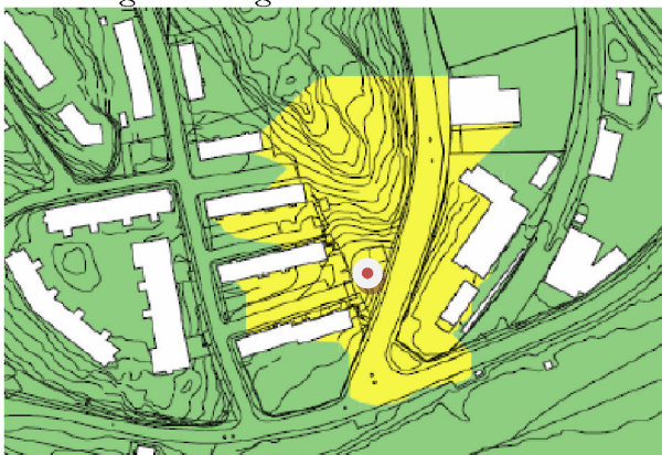
Figur 10. Inom gult område riskerar riktvärdet att överstigas vid pålning i position 1. Beräkningspositionen framgår av figuren. (WSP, 2009-03-19)
