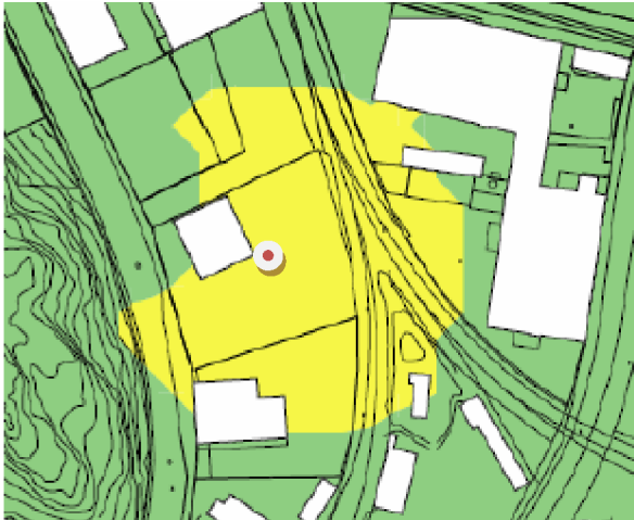
Figur 17. Inom gult område riskerar ljudnivån överstiga 45 dBA inomhus vid borrning i den östra delen. Beräkningspositionen framgår av figuren. (WSP, 2009-03-19)
