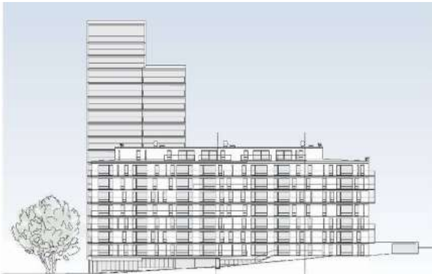
Låghusets fasad mot väster/"kvartersgatan". I bakgrunden höghusets två delar. "Kvartersgatan" har en kraftig lutning vilket gör att de olika garageinfarterna respektive bostadsentréerna ligger på olika nivåer.
