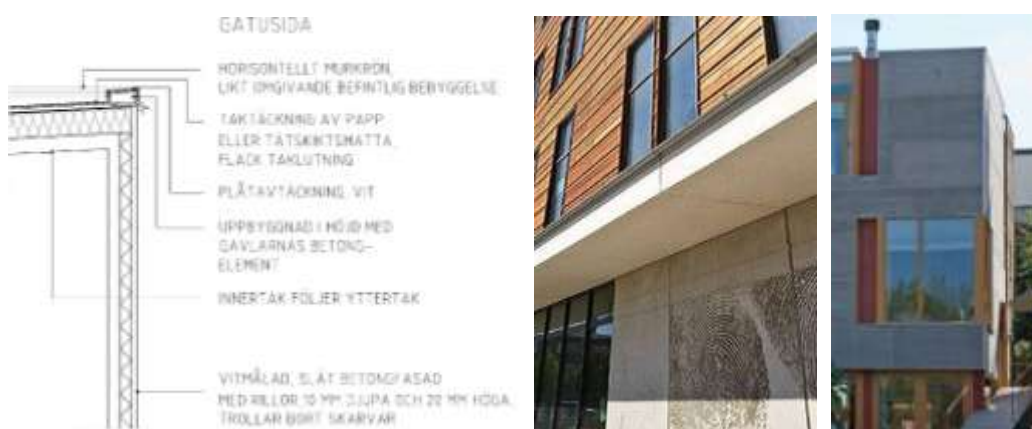
Detalj av takfot mot gata samt referensbilder som visar exempel på möjliga fasadmaterial och kulörer
