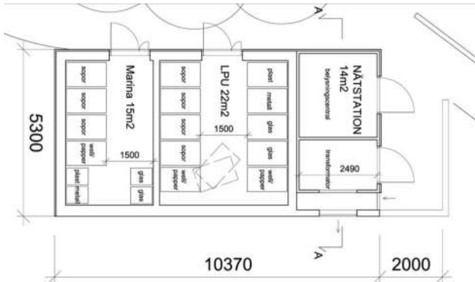
Komplementbyggnad för avfallshantering och elnätstation – föreslagen planlösning
