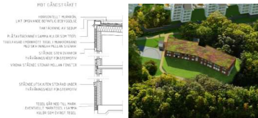
Detaljsnitt genom förskolans fasad och takfot samt illustrationsbild av grönt tak och betonggräs på värdzon
