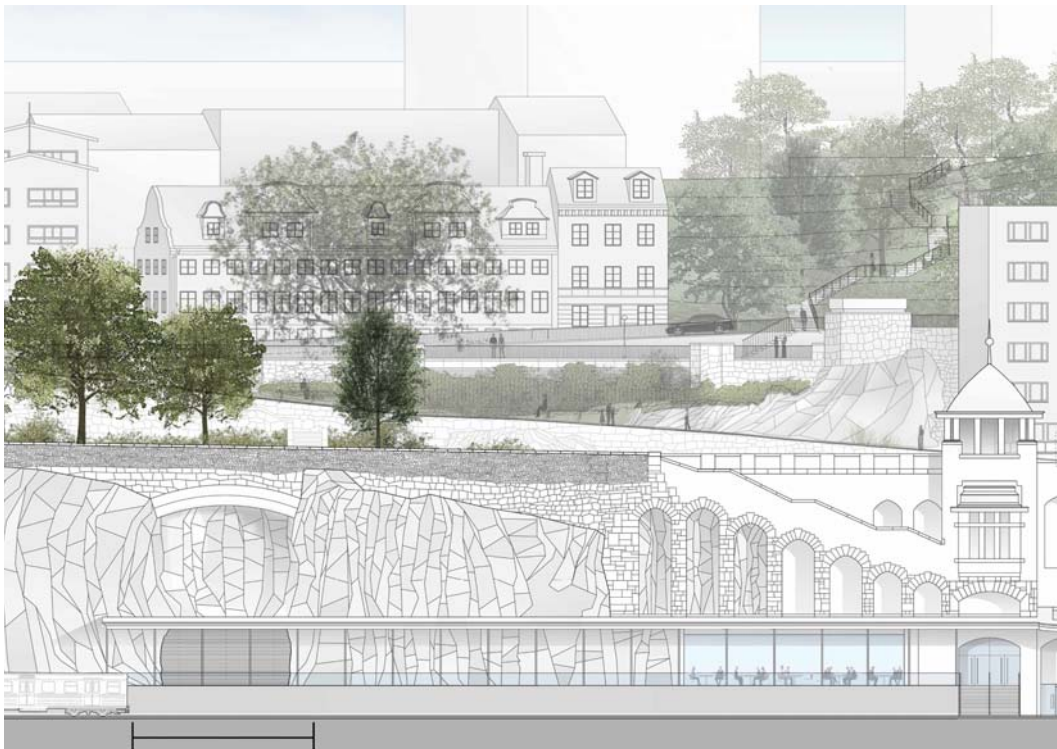
Utluft från bussterminalen föreslås anordnas i skärmtaket, öster om Lokattens trappor, under valvet som Katarinavägen går över. En linjemarkering i bildens nedkant visar läget. Bild: Foster+Partners och Berg Arkitektkontor.
