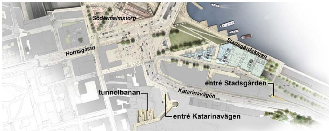
Illustrationsplan torgplan. Entré vid Katarinavägen kopplar till bussterminal, tunnelbana och handelsplatsen på kaj- respektive mellanplan. Bild: Foster+Partners och Berg Arkitektkontor.
