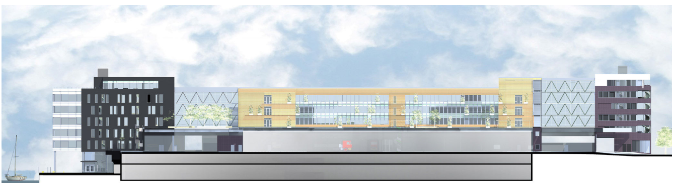
Fasad mot den östra bostadsgården. Bussdepåns kontorsutrymmen ger en varm utformning och bostadsgården är belägen ovanpå bussdepåns in- och utfartsramper.
