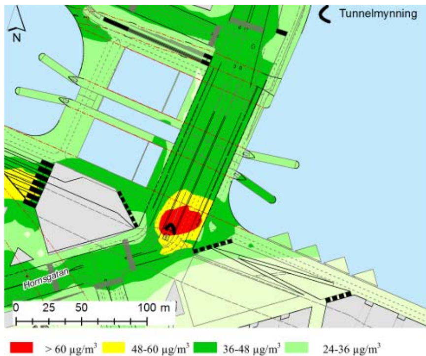
Figur 7.1.6. Mynningen på Skeppsbron, spridningsberäkningar för planförslaget för nya Slussen. Total halt av kvävedioxid, dygnsmedelvärde, 2 meter ovan mark samt i bronivå.
