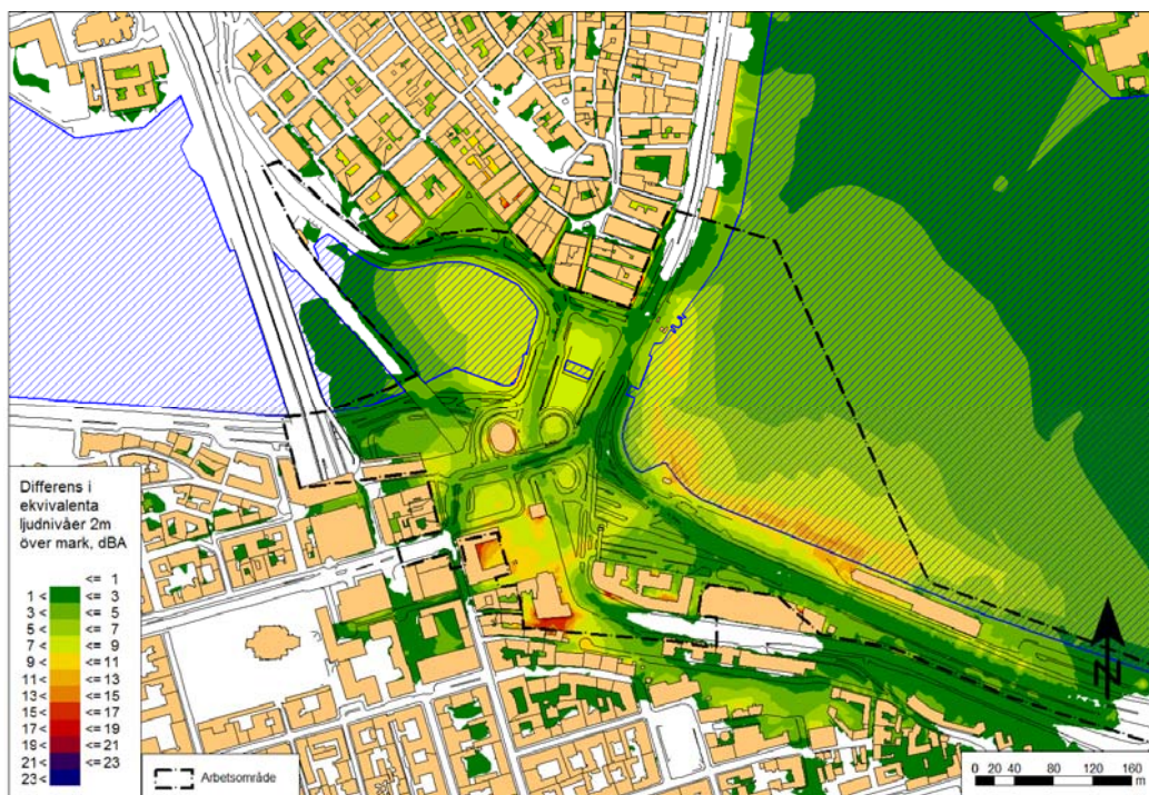
Figur 8.2.1. Beräknad differens mellan sammanlagd nivå av och trafikbuller och byggbuller på grund av projektet och nuvarande trafikbullernivå i genomförandeskede A.
