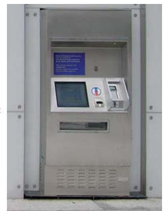
biljettautomat infälld i vägg, Nydalen, Oslo
