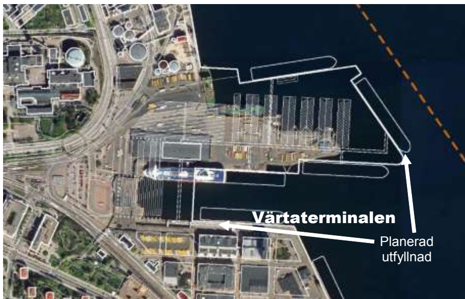
Bild 3. Planerad utfyllnad av Värtapiren och Värtabassängen.
