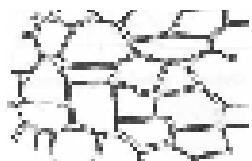
Kryss- eller polygonmur – byggd på betongplatta
