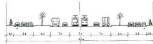
Typsektion genom Lövsta allé vid spårtrafik i körbanans mitt. Allékaraktären bibehålls.
