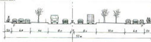
Typsektion genom Lövsta allé vid 70km/h och 4 körfält.
