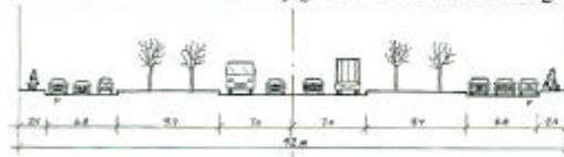
Typsektion genom Lövsta allé vid 50km/h och 4 körfält.
