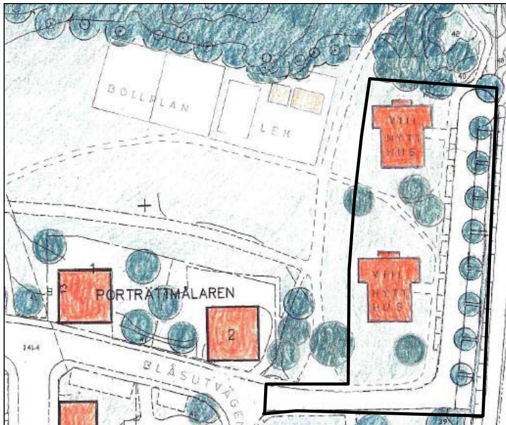
Bild 2. Utbyggnadsförslaget med markanvisningsområdet och de nya byggnaderna markerade. De nya byggnaderna har en egen angöringsgata inom kvartersmarken där parkering kan anordnas.
