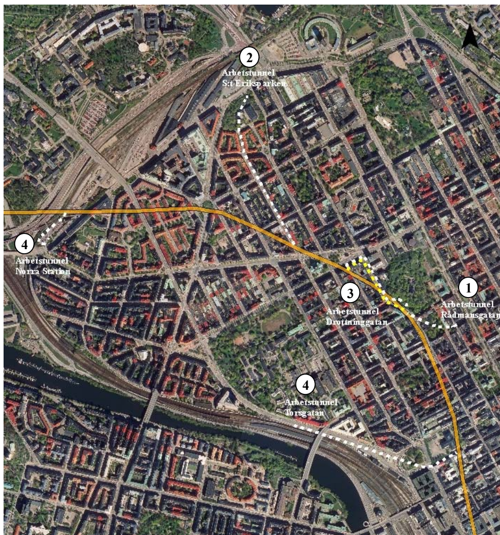
Figur: De tre alternativen Drottninggatan, Rådmanngatan och S:t Eriksparken samt alternativet "ingen tunnel" vilket innebär bergutlastning via arbetstunnel Norra Station och/eller arbetstunnel Torsgatan.
