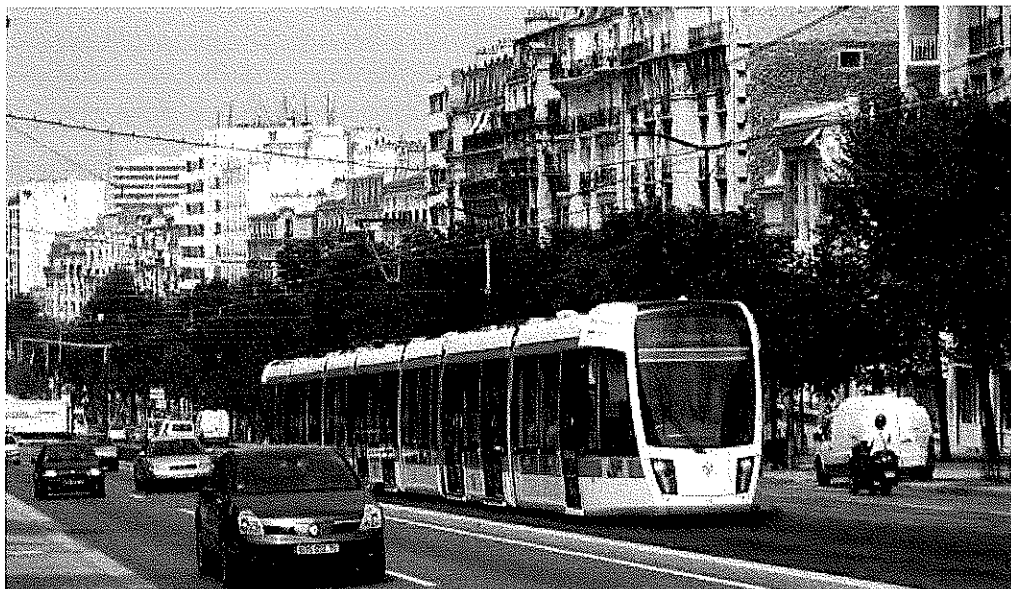
Figur 8 Spårväg i Paris på egen bana, vilket borgar för hög framkomlighet och god driftsekonomi. Foto: PG Andersson
