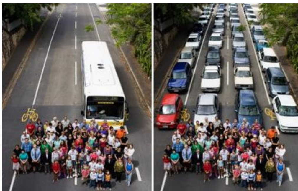
Figur 5 Jämförelse av transporteffektiviteten mellan buss och bil. Bilden visar antalet bilar jämfört med antalet bussar som krävs för att transportera samma mängd resenärer.
