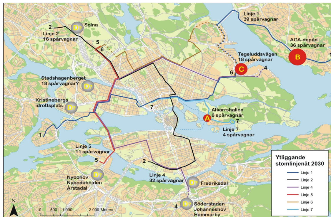
Figur 33 Figuren visar fordonsbehovet för full utbyggnad av föreslaget stomnät 2030 med spårvägstrafik, möjliga depålägen (röda och gula cirklar) samt kapacitet och möjlig utbyggnadsordning för föreslagna depålägen.
