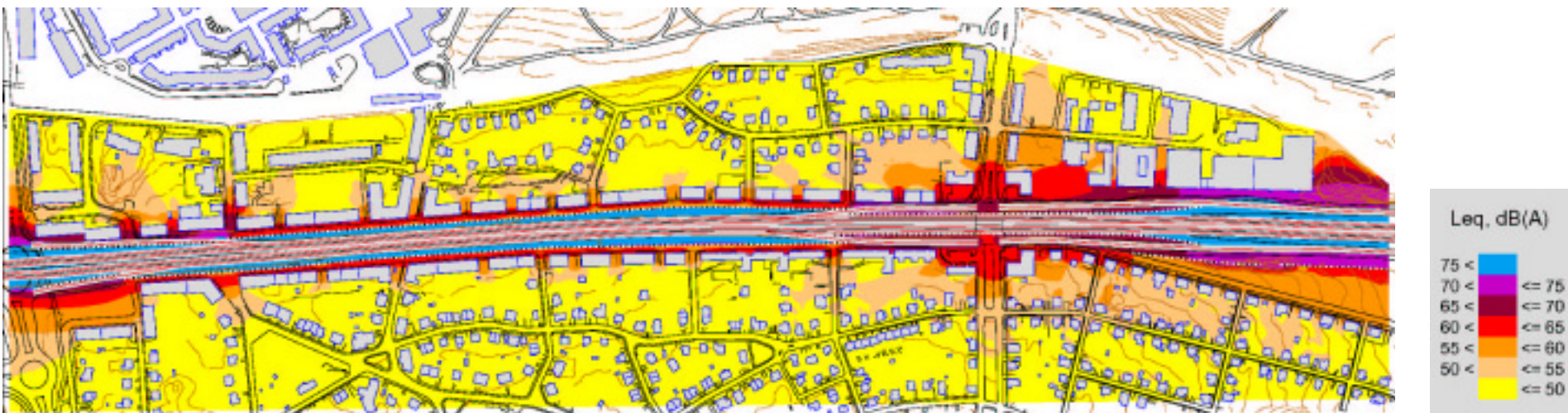
Situation efter åtgärder, 1,5meter över mark.
