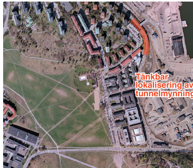
Figur 8.9 Tänkbar lokalisering av tunnelmynning mot frihamnen från alternativ D
