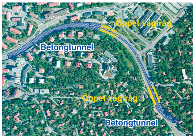
Figur 8.11 Södra Kungsvägen, Lidingö. Blå markering anger uppskattat schaktbehov för betongtunnel (överdäckning).
