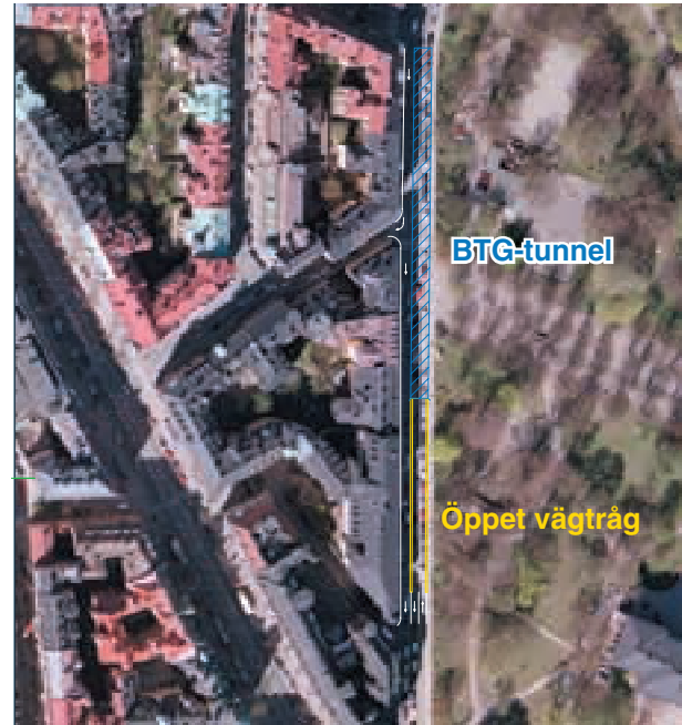
Figur 8.5 Exempel på lösning med rampanslutningar vid Engelbrektsgatan. Blå markering anger uppskattat schaktbehov för betongtunnel.
