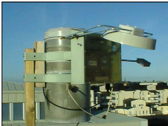
Figur 2. T v lockprovtagaren och t h kvicksilverprovtagaren som användes vid depositions-mätningarna på Södermalm.
