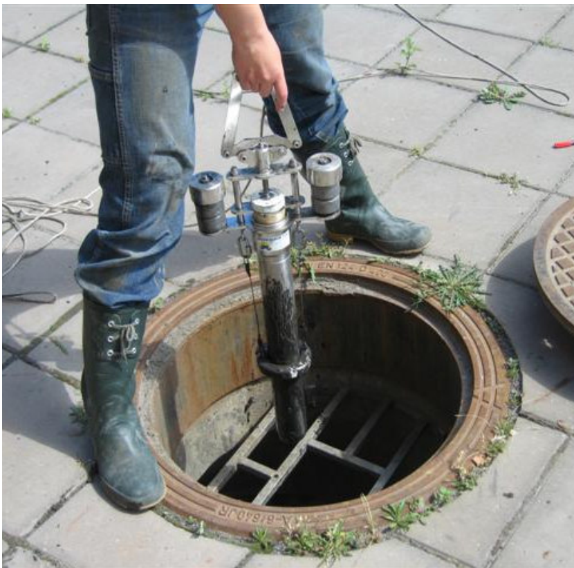
Figur 12. Sedimentprovtagning med rörhämtare i Gårda-anläggningen.
