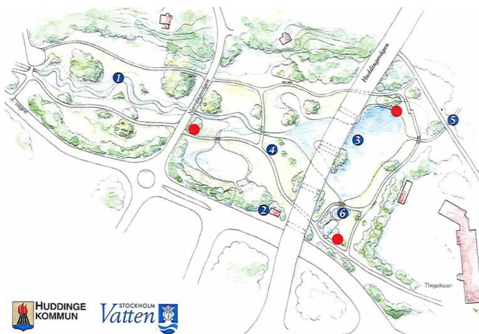
Bild 2: Skiss över kyrkdammen vid Huddinge centrum. 1. Fullersstaån kommer från Gömmaren. 2. Dagvattnet från Huddingevägen renas i ett magasin innan det släpps ut. 3. Kyrkdammen. 4. Cykel- och promenadvägar. 5. Ytterligare ett inlopp till Kyrkdammen. 6. Fördämning och utlopp till Trehörningen.
