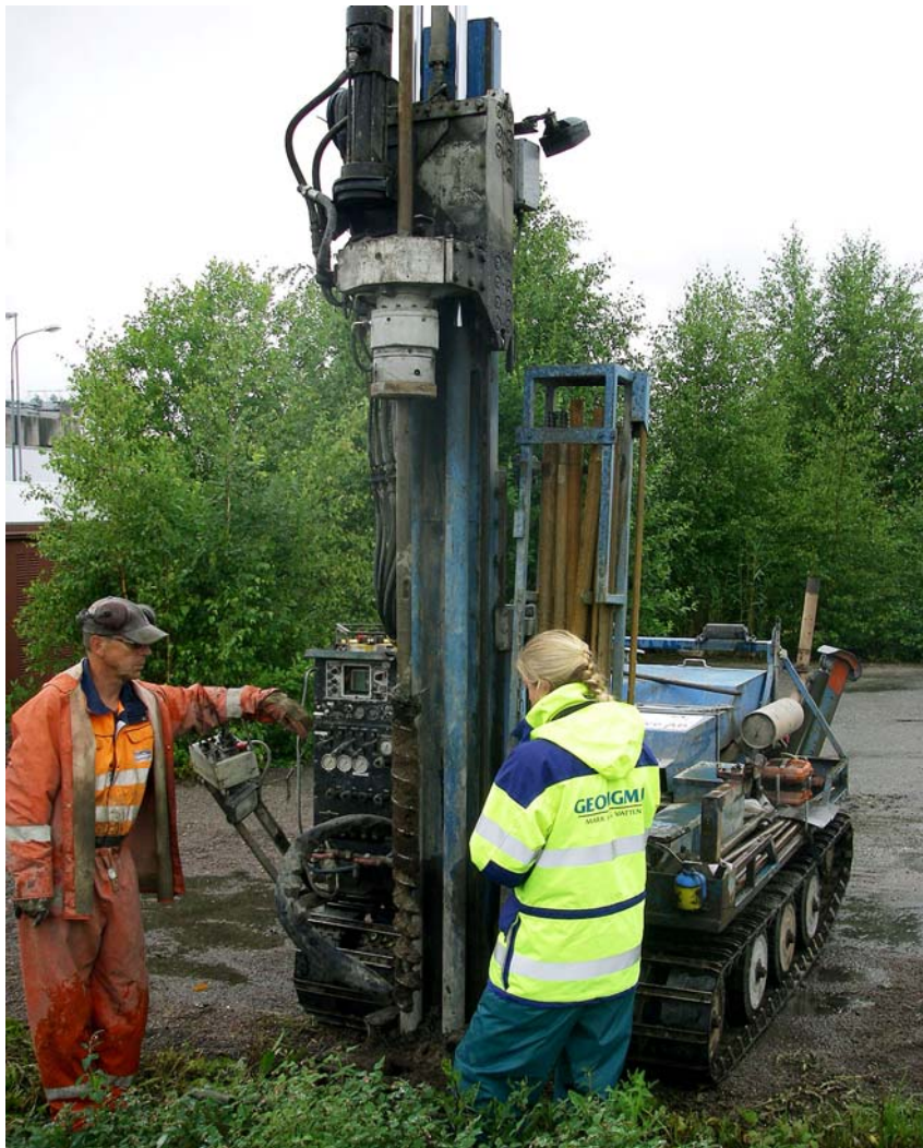
Undersökningar av markföroreningar har genomförts vid 13 olika strandnära platser, bilden visar maskin för skruvborrning. Foto: Gert Nilsson, Geosigma AB.
