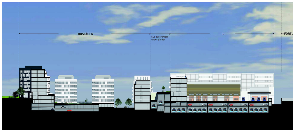
Sektion genom planområdet som visar hur bussdepå med ramper förhåller sig till bostäderna. Slutsatsen i riskanalysen är att verksamheten går att kombinera med bostäder och att individ- och samhällsriskerna för tredje man är acceptabel. Brunnberg & Forshed
