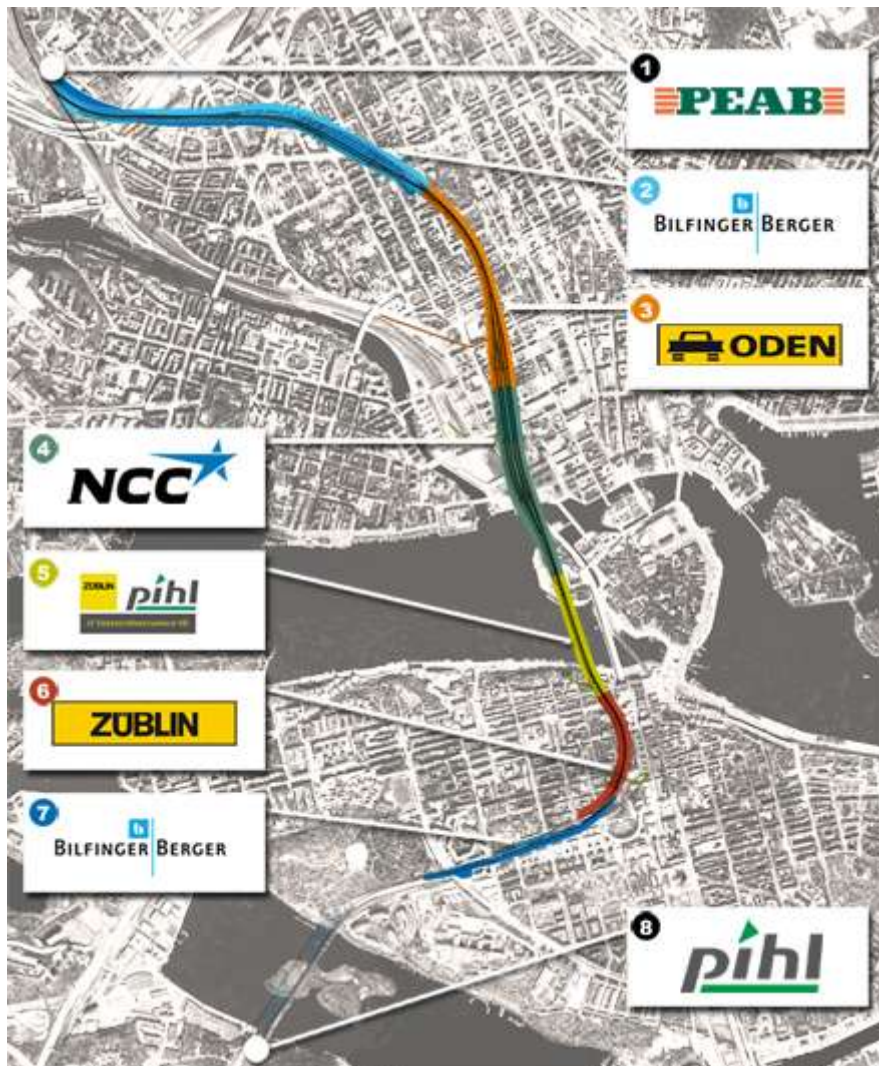
Figur 4. Citybanans sträckning, station Stockholms södra – Tomtebodan, med några av de största entreprenaderna. (Källa: www.trafikverket.se )
