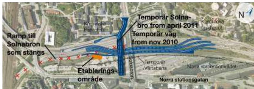
Figur 3. Norra stationsområdet med temporär Solnabro och temporär väg och järnväg. (Källa: www.trafikverket.se )
