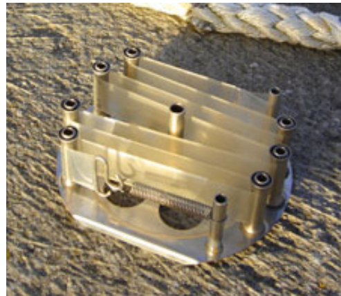
Bild från ALS hemsida föreställande en ett membran för metallanalyser och en s.k. spindel med monterat membran för organiska analyser.
