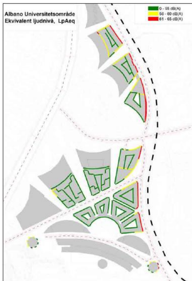
Figur 5.10.3 Ekvivalenta ljudnivåer vid bostadsfasad utan åtgärder.
