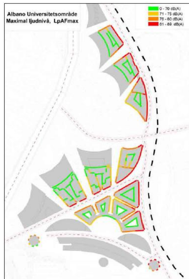
Figur 5.10.4 Maximala ljudnivåer vid bostadsfasad utan åtgärder.
