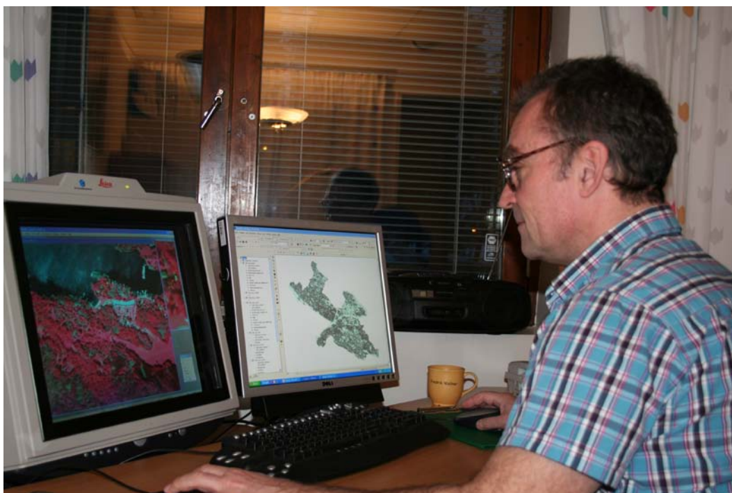
Bild 2. Flygbildstolkningsstation för digital fotogrammetri. Foto: Mats Williamson.
