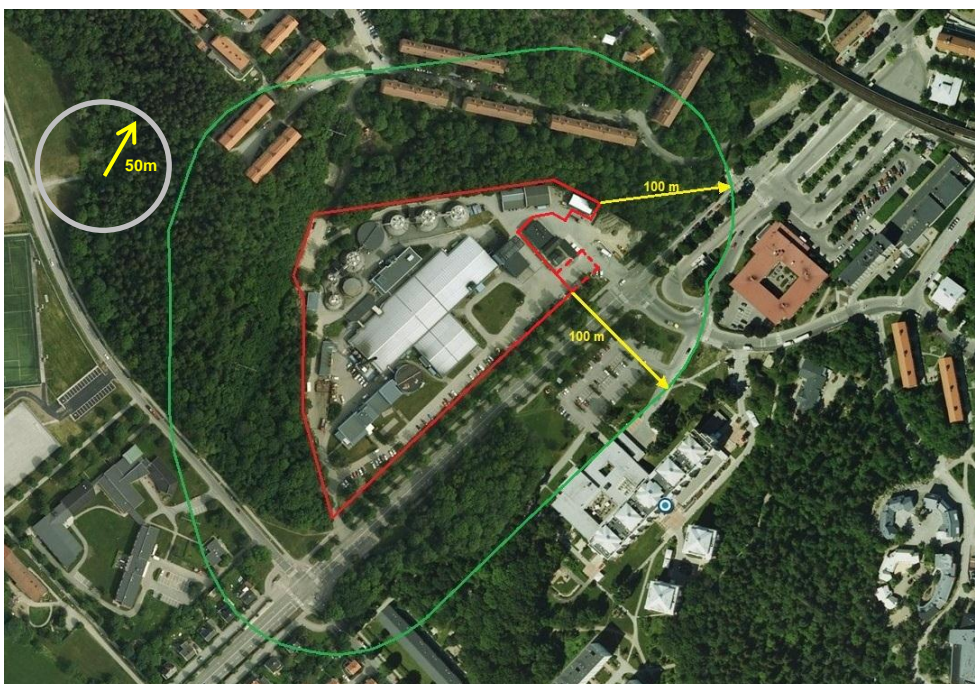
Bild 8, Område runt Åkeshovsanläggningen inom vilket bostäder inte bör uppföras närmare än 100 m från fastighetsgränsen (rött område). Infarten till anläggningen (streckat område) bortses här ifrån.
