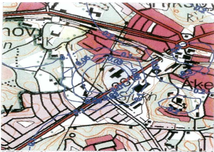
Bild 6. Luftfrekvens för medianmånad (% av tiden) innan införd åtgärd (avsmalnande avslut på skorstenen). ISO linjer 0,01, 0,03, 0,05, 0,1, 0,2, 0,3 %
