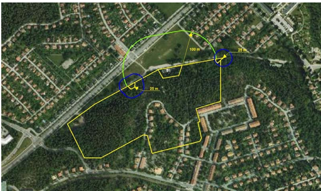
Figur 7. Område runt Nockebyanläggningen inom vilket bostäder inte bör uppföras närmare än 100 m från byggnaden, samt inom 25 m från tunnelmyningarna.
