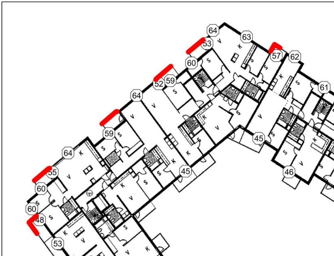
Figur 5. Bullerkartering av föreslagen husdel inom programområdet som är starkt utsatt för buller. Bilden visar våningsplan 9, med delvis glasade balkonger enligt röd färg 10 . Lägenheter som i bullerredovisningen har fått bullerskärmar har utgjorts både av lägenheter som bara har boningsrum mot bullrig sida och lägenheter som har rum mot både tyst och bullrig sida 11 .
